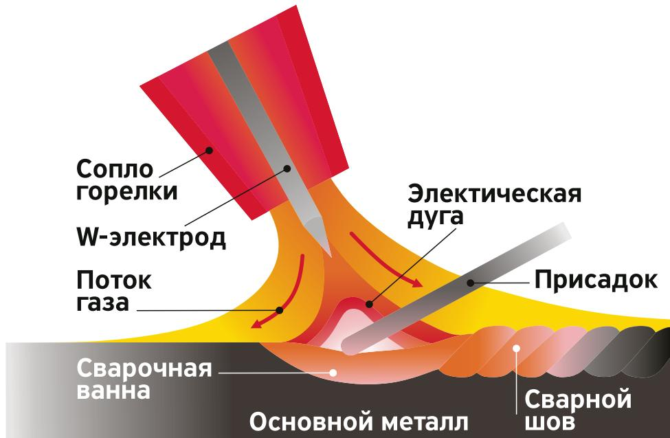
Аргонодуговая сварка подразумевает включение в процесс двух рук сварщика: одна рука манипулирует сварочной горелкой, вторая осуществляет равномерную подачу присадочного материала в сварочную ванну. Существует две техники манипуляции горелкой – с опорой на сопло и без опоры.
